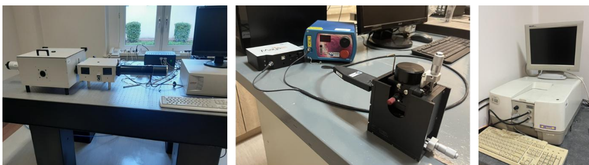
Fot. 8. Układy doświadczalne, na których badania do swoich rozpraw doktorskich przeprowadzali dr Blanka Ziomkowska, dr inż. Michał Cyrankiewicz oraz dr inż. Tomasz Wybranowski. Od lewej: spektrofлуorymetr do rejestracji widm fluorescencji oraz stacjonarnej anizotropii fluorescencji, spektrometr ramanowski i spektrofotometr UV-Vis.
