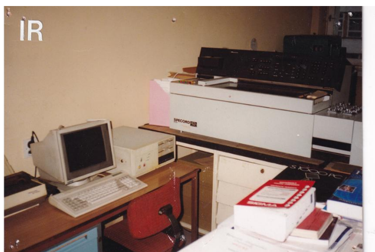
Fot. 2. Zestawy doświadczalne - kolumna chromatograficzna i spektrofotometr IR, na których badania do swojej rozprawy doktorskiej prowadził dr Jerzy Różyczka.
