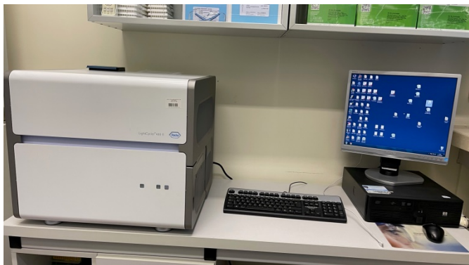
Termocykler LightCycler 480II firmy Roche Diagnostics (aparat dedykowany do RT-qPCR)
