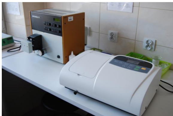
Mikroprocesorowy spektrofotometr jednowiązkowy Spekol 11 oraz spektrofotometr UV-VIS model UV5100 (Biosens).
