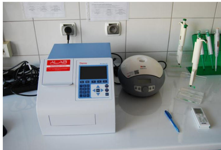
Spektrofotometryczny czytnik do mikropłytek 96 i 384 dołkowych z monochromatorem MULTISKAN GO (THERMO SCIENTIFIC).
