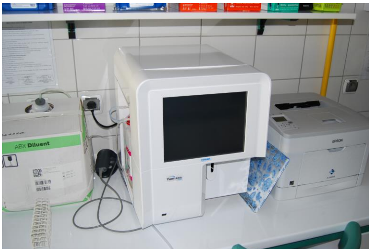
Analizator hematologiczny (5 Diff) Yumizen H 500 wyposażony w drukarkę zewnętrzną.
